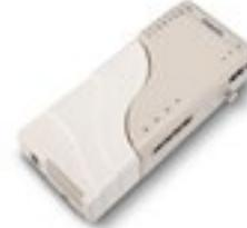
**FiberXport:** Um einen Werks-Reset durchzuführen, trennen Sie das Gerät 10 Minuten vom Strom. Anschließend können Sie das Gerät wieder anschließen und Ihre gebuchten Dienste wie gewohnt nutzen.
