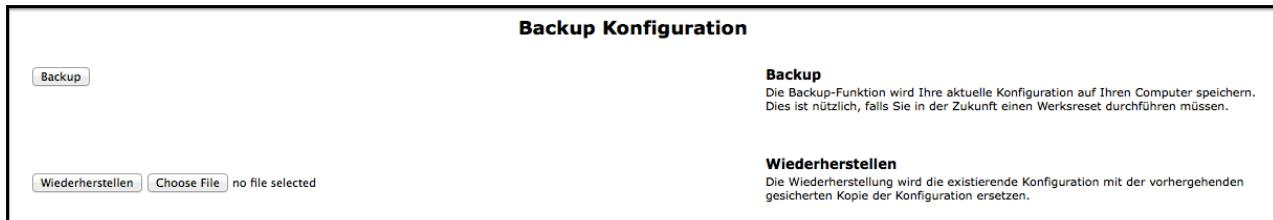
Um die existierenden Konfigurationseinstellungen zu sichern, klicken Sie auf **Backup**. Der Browser lädt automatisch eine Datei mit den Konfigurationseinstellungen herunter.
